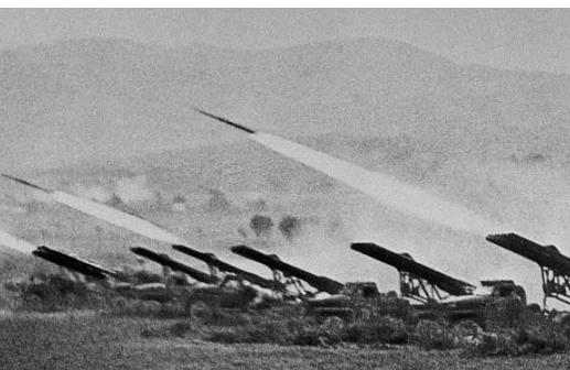
Batteries de Katioucha, Stalingrad, 1942. Les « Katioucha », lance-roquettes d'une portée de 5km sont appelés aussi « orgues de Staline », en raison de leur bruit caractéristique. Coll. RIA Novosti archive
